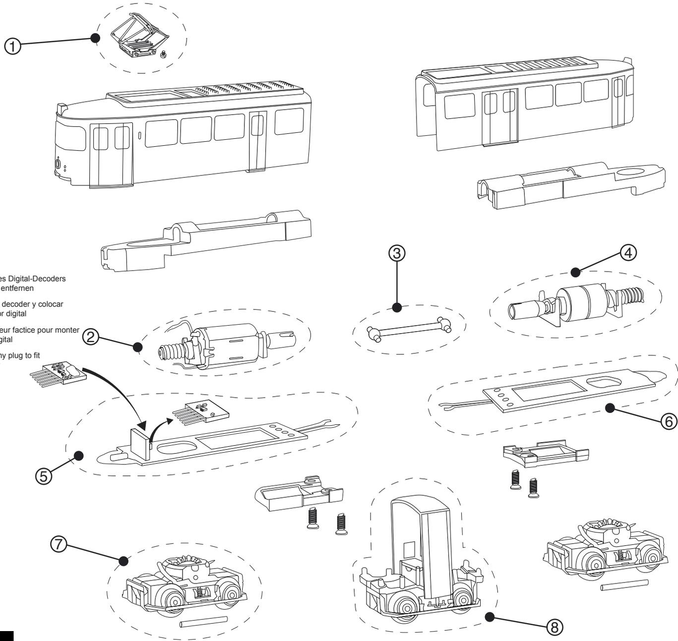
Zum Einbau des Digital-Decoders
