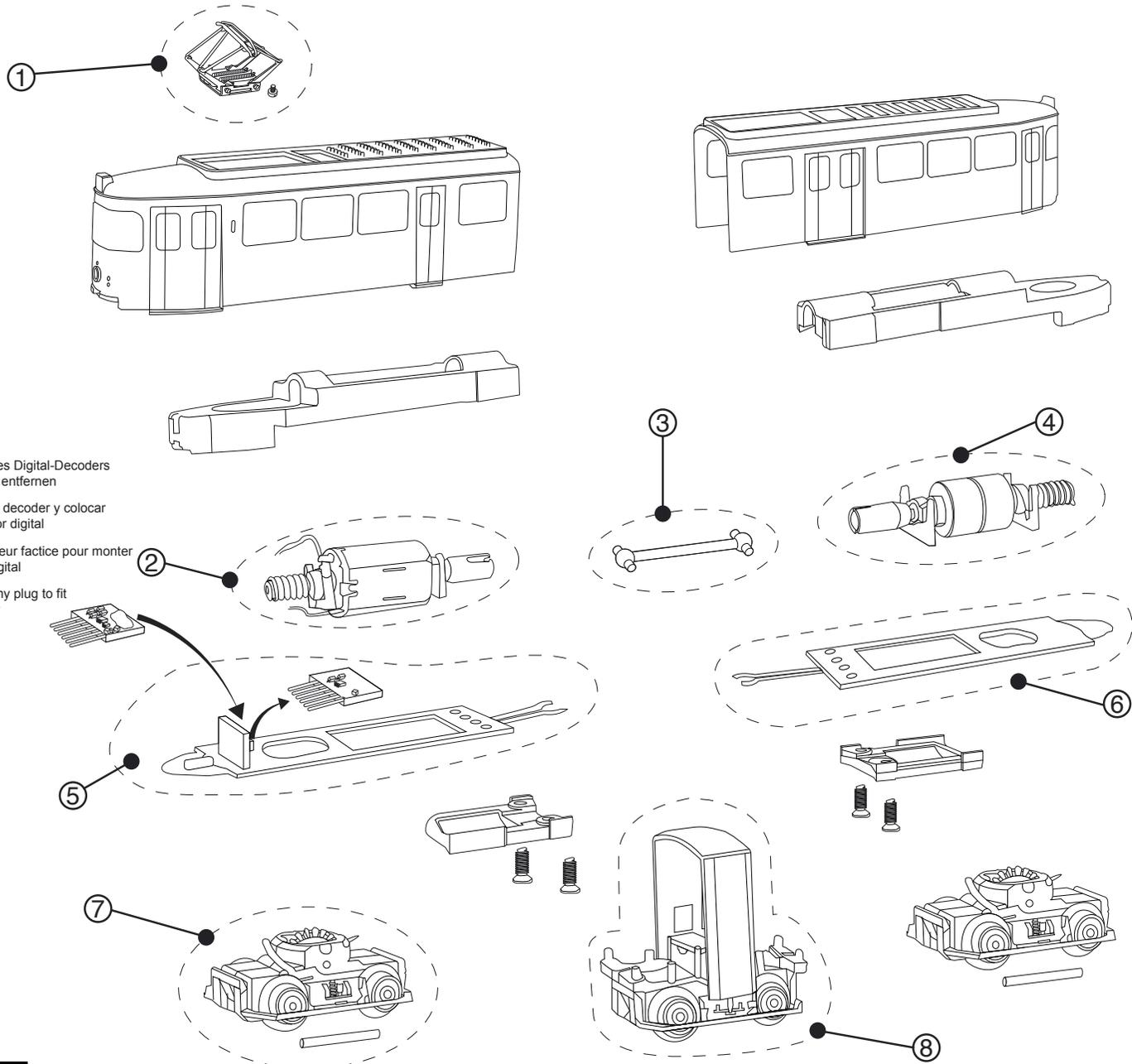
Zum Einbau des Digital-Decoders
